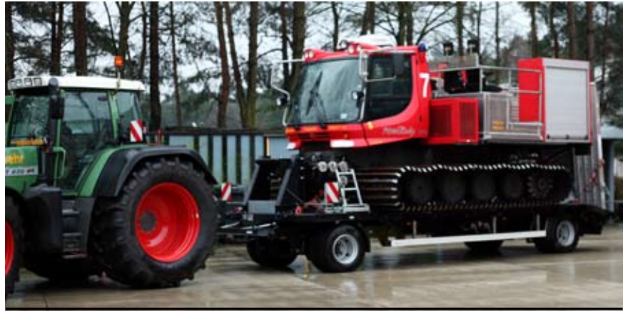
Sondergerät einer Bundeswehrfeuerwehr zur Brandbekämpfung in Mooregebieten
