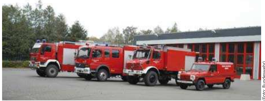
Feuerlöschfahrzeuge (von links nach rechts): Geräterüst-, Gebäudebrand-, Waldbrand-, Einsatzleitwagen
